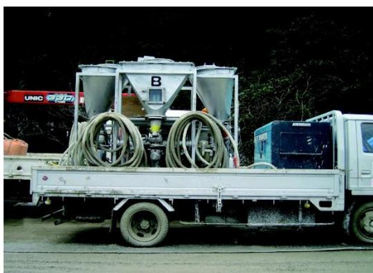
装填機搭載状況 (4 t 車)
